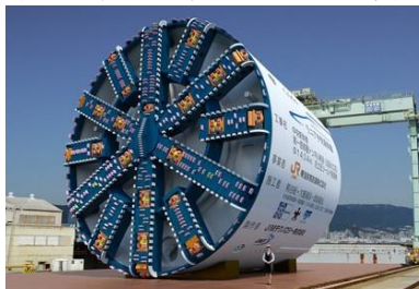
（直径 15 m のシールドマシン）
